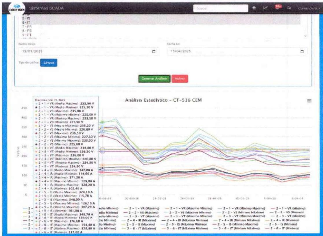
Se realizaron monitoreos y controles en medición frontera con EDEA, con sistema tele medición en línea MT Gral. Belgrano para mediciones de Calidad de Servicio y Producto Técnico.
