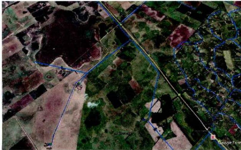
Se proyecta realizar un tendido trifásico de media tensión de línea convencional sobre calle pública y con postación de hormigón armado.
